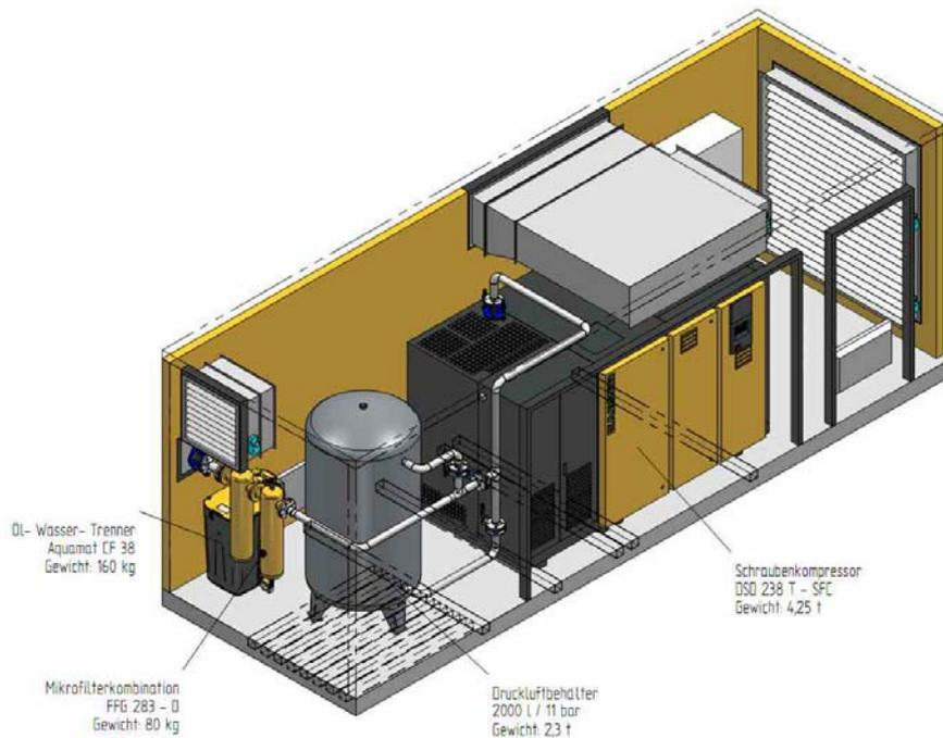
Die elektr. Nennleistung des Kompressormotors beträgt 132 kW. Die neue Anlage wurde in die vernetzte Druckluftsteuerung eingebunden und fungiert nun als Grundlastanlage.
