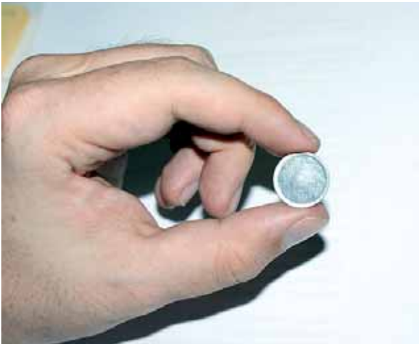
▲ Die Größe der Minitemperaturdatenlogger entspricht ca. der einer 1-Euro-Münze, die Kosten betragen ca. 30 Euro.
