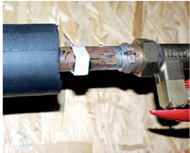
▲ Die Montage der Minitemperaturdatenlogger an Rohroberflächen ist sehr einfach.
