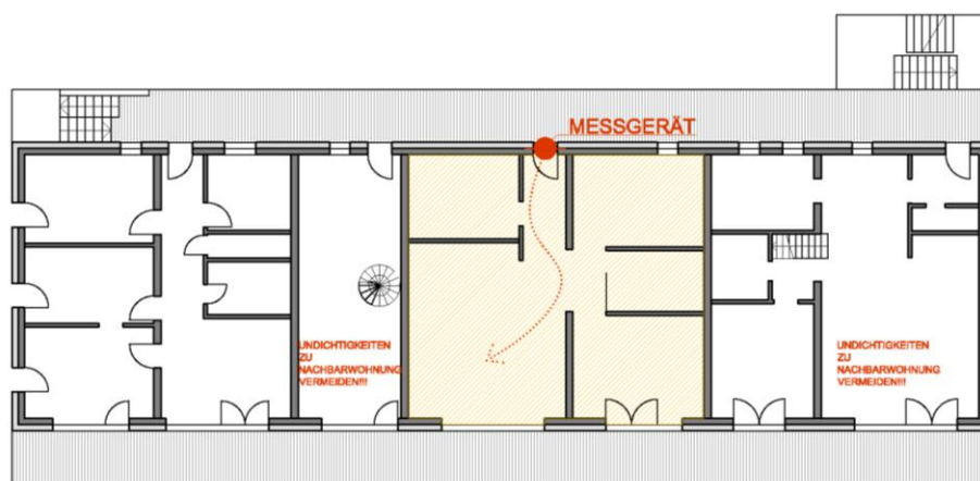
Grafik 7: Luftdichtheitsmessung beim Gebäudetyp „Laubengang“
