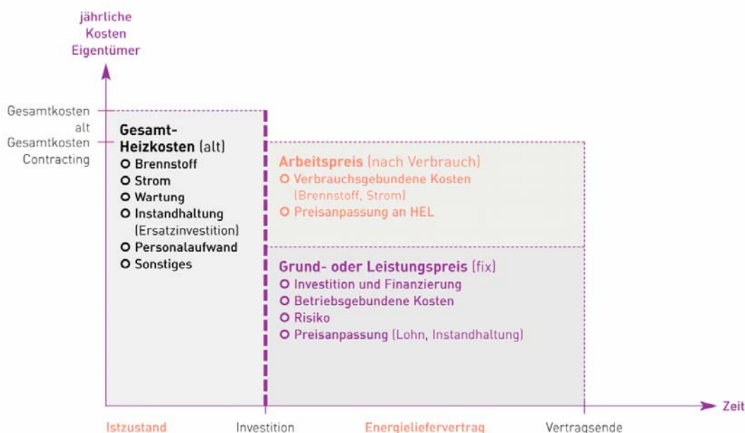
Abbildung 1: Kostenaufstellung des Liefer- bzw. Anlagen-Contractings
